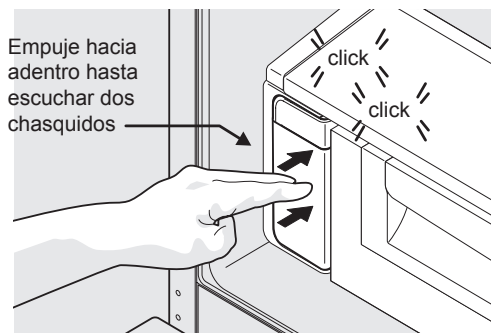
Figura 51 Vuelva a instalar el filtro de agua
